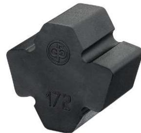
Die Pakete der N-EUPEX DS Baureihe werden druck- und biegebeansprucht. Charakteristisch ist eine lineare Drehfederkennlinie. Bei Zerstörung der Pakete drehen sich die Metallteile ohne Kontakt gegeneinander, die Kraftübertragung ist getrennt. Durch den Einbau neuer Pakete ist die Kupplung wieder verwendungsfähig. Die überlastverfende Eigenschaft der N-EUPEX DS Baureihe wird z. B. bei besonders empfindlichen Maschinen gefordert.
