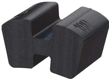
Die Pakete der N-EUPEX Kupplung werden druckbeansprucht. Es ergibt sich eine progressive Drehfedercharakteristik. Bei Zerstörung der Pakete findet Metallkontakt der Nabenteile statt. Dadurch wird das Drehmoment für einen kurzen Zeitraum als "Notlaufeigenschaft" weiterhin übertragen.
