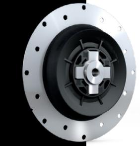
Mit ihren drehweichen Eigenschaften dämpft die CENTAX-K Drehschwingungen und Stöße und gleicht betriebsbedingte axiale und radiale Verlagerungen aus. Das Gummielement steht in verschiedenen Ausführungen zur Verfügung.
