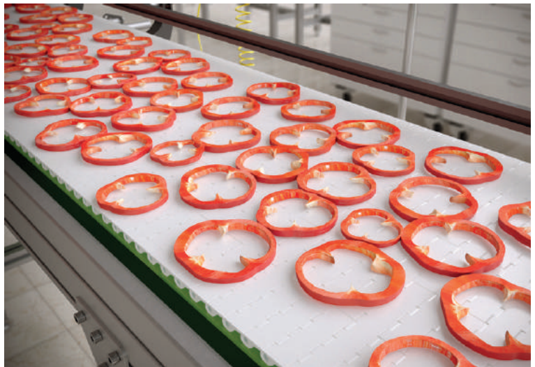
Förderband mit einem KleanTop-Band der Rexnord-Serie 1015
