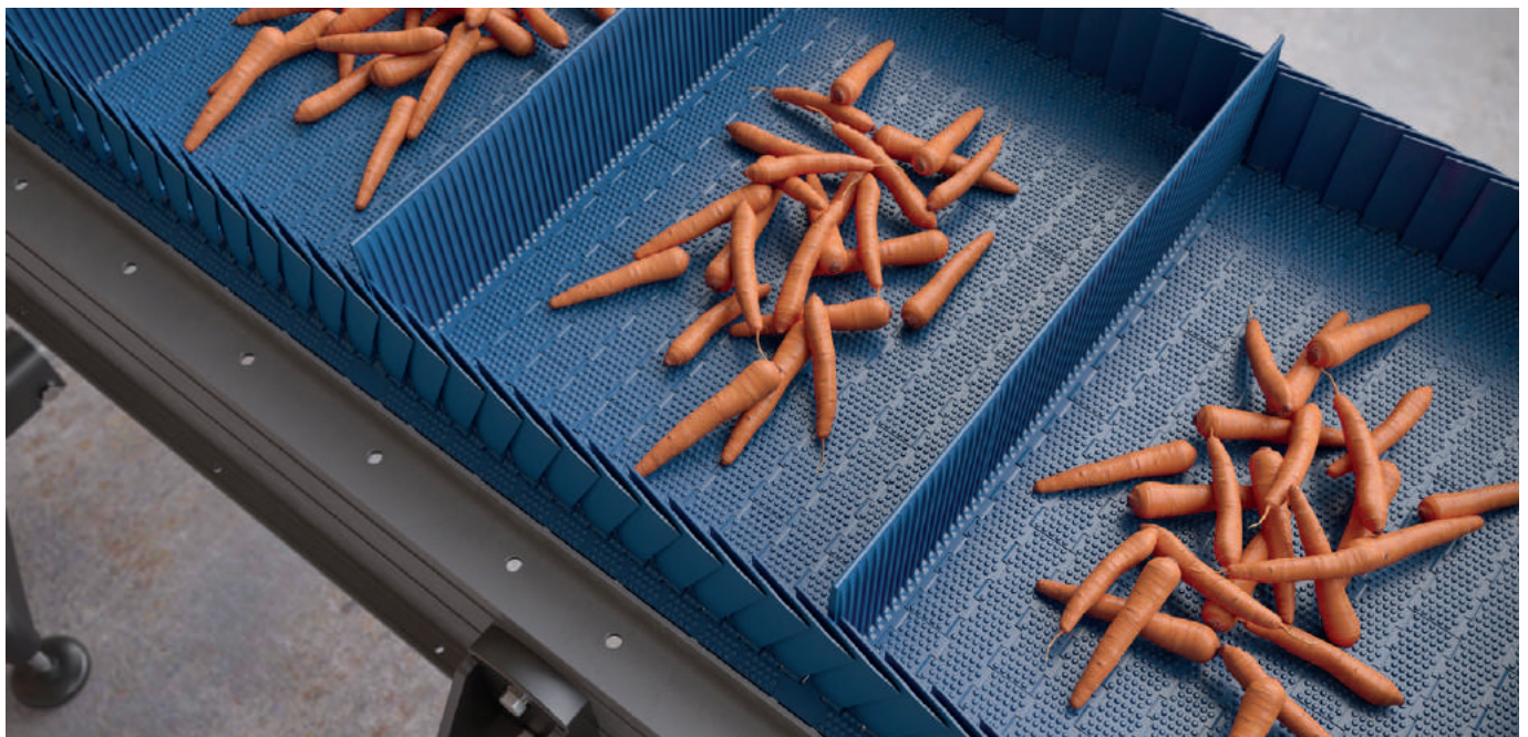
Förderband mit einem KleanTop-Band der Rexnord-Serie 1011
