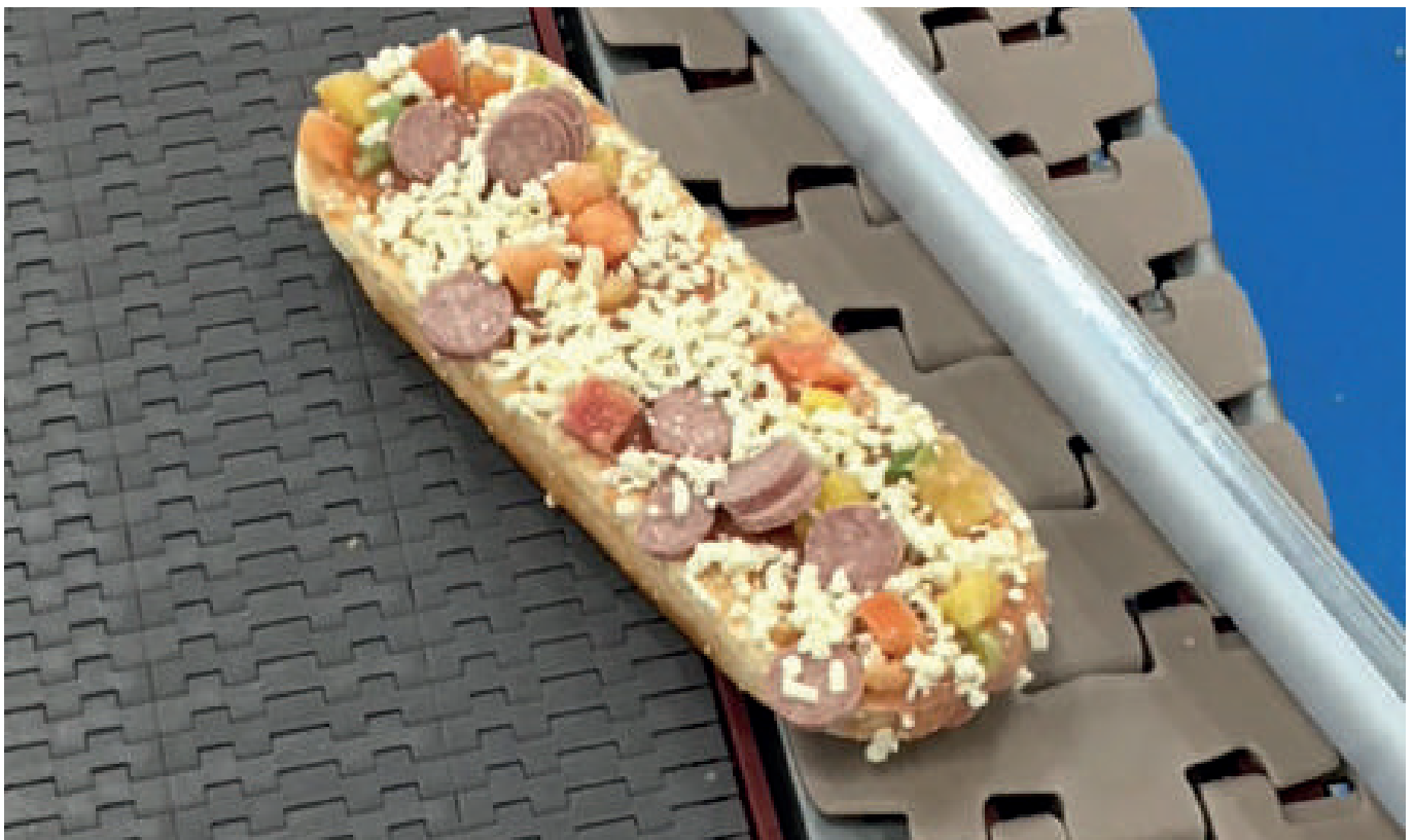
Förderband mit Rexnord KleanTop-Ketten der 395-Serie.
