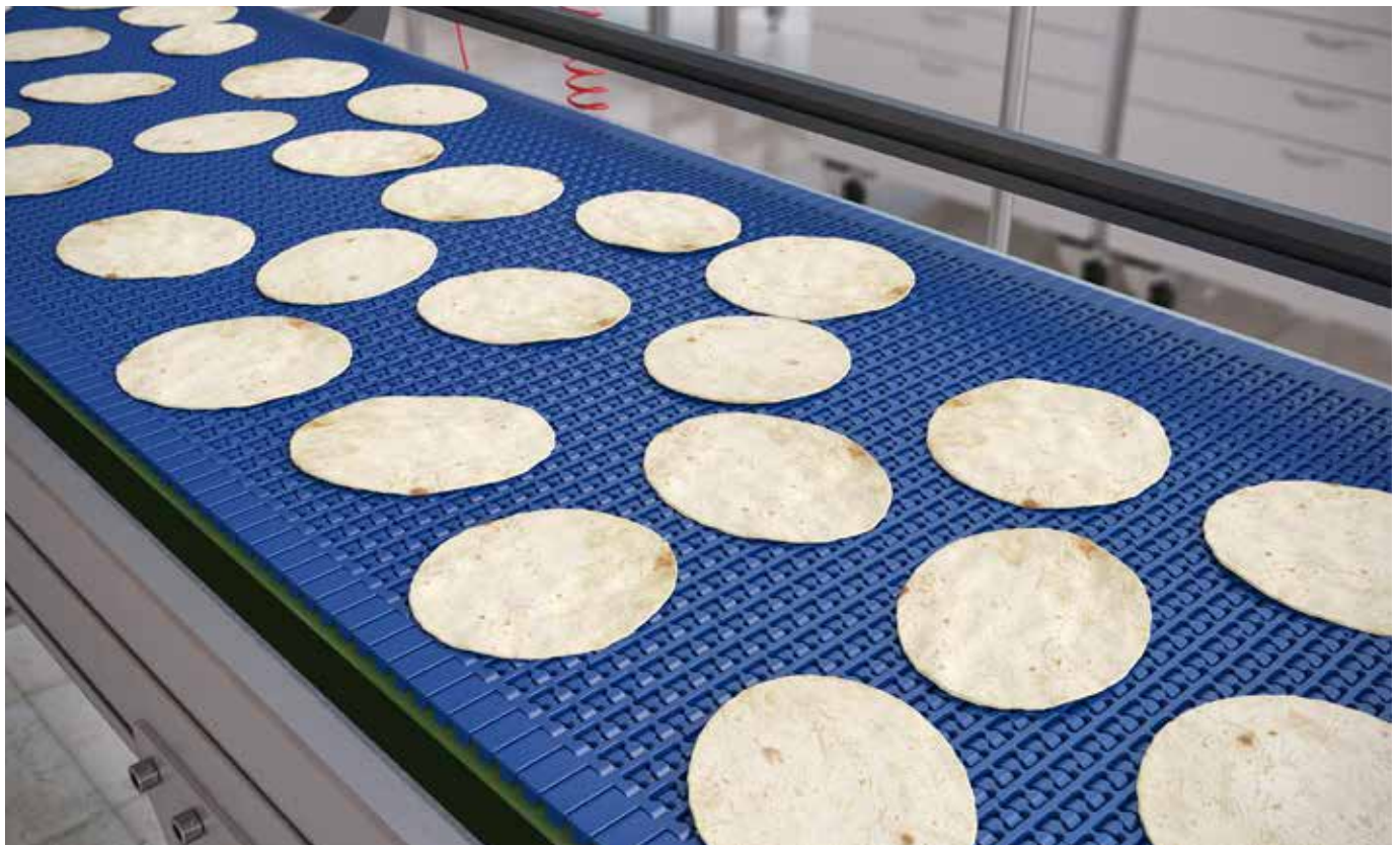
Förderband mit Rexnord KleanTop-Ketten der 596-Serie.
