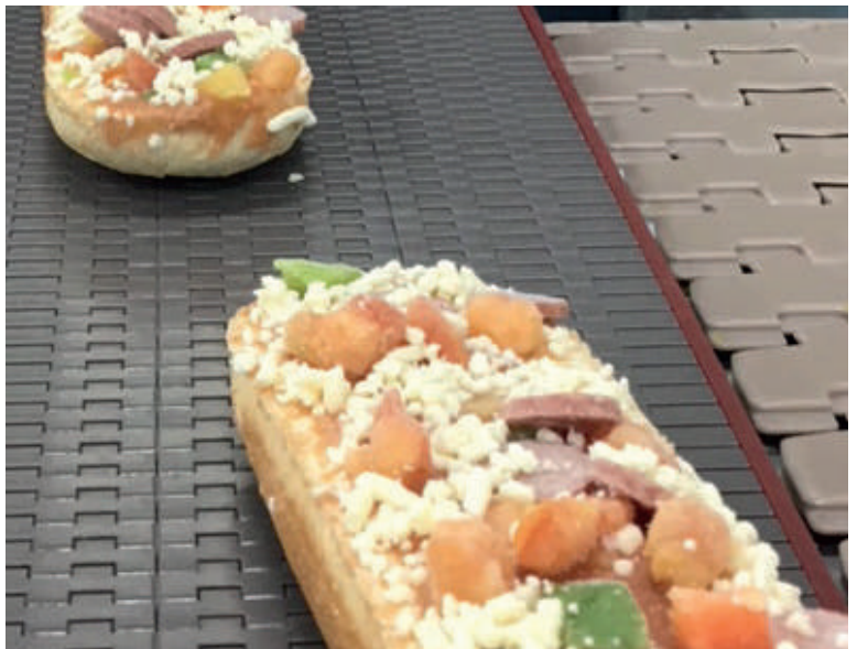
Förderband mit Rexnord KleanTop-Ketten der 395-Serie.
