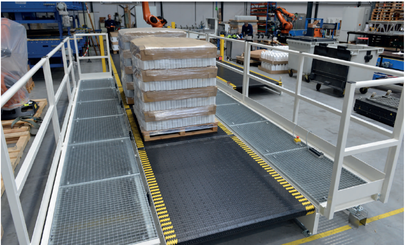
Förderband mit Rexnord MatTop-Kette der 1020-Serie
