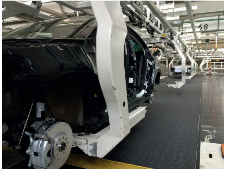
Förderband mit Rexnord MatTop-Kette der 1020-Serie
