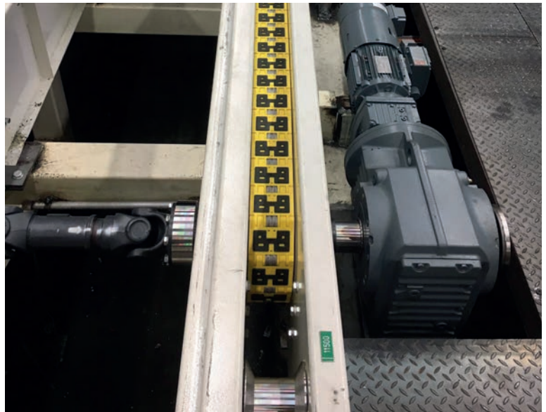
Förderbänder mit MatTop-Ketten der Rexnord-Serie 3125 HYB 12
